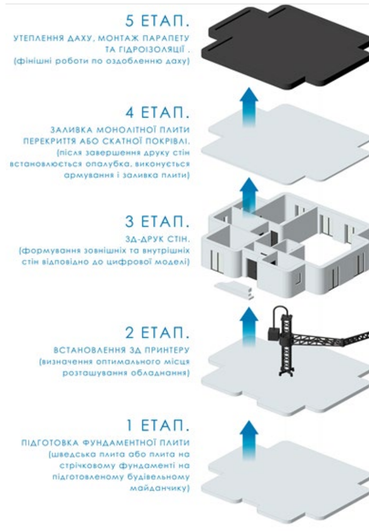
Рис.2. Етапи будівництва за допомогою 3D-друку. Автор О. Чорний
