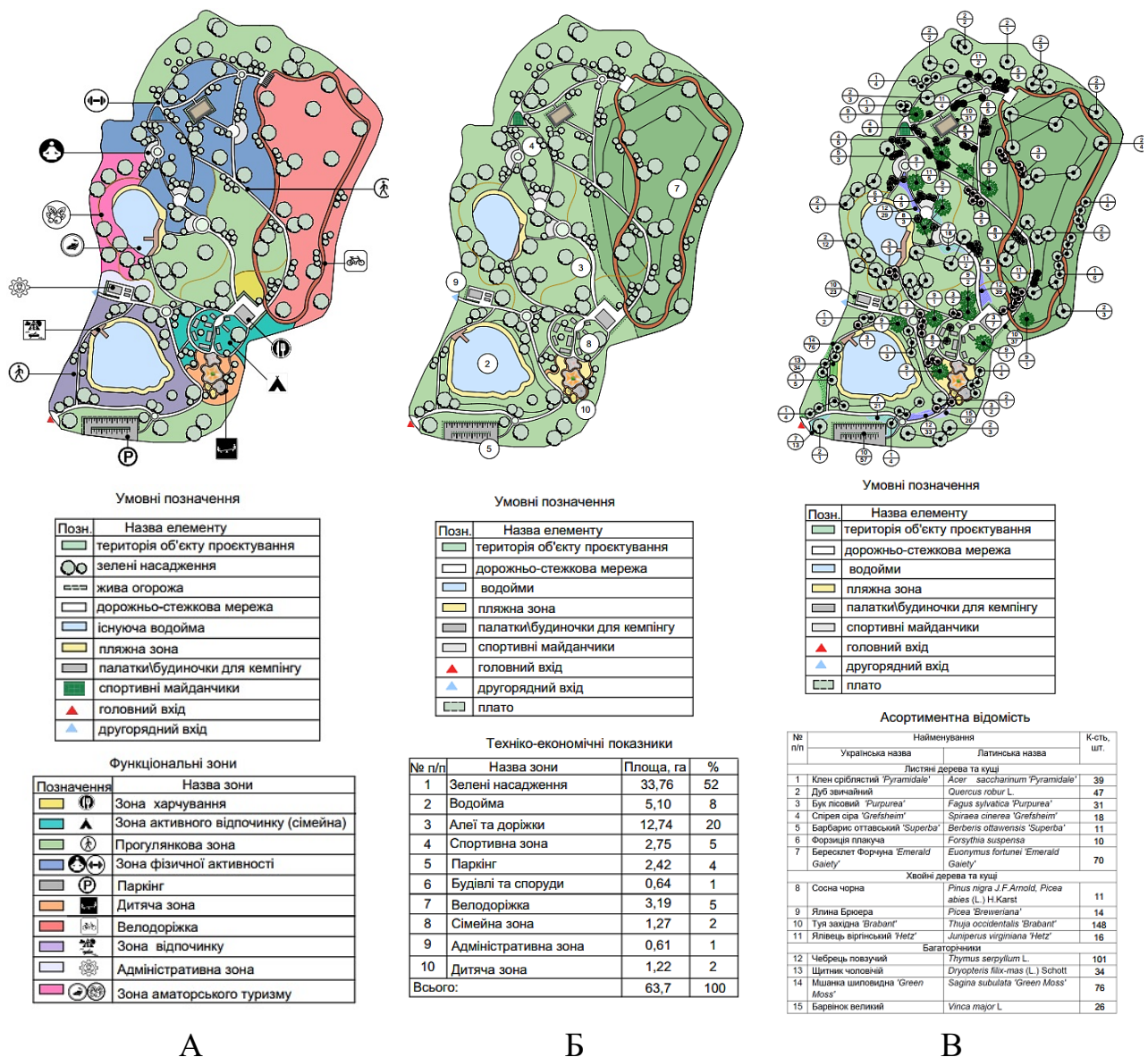
Рис. 2. Проектні пропозиції щодо ревіталізації території, порушеної полігоном твердих побутових відходів (за матеріалами курсової роботи студентки ХНУМГ ім. О.М. Бекетова Тарасової А.Ю.): а – схема функціонального зонування; б – генеральний план; в – дендроплан
