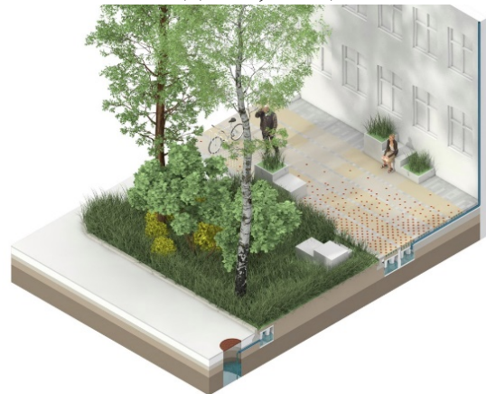
Рис. 3 Розріз вулиці зі застосуванням кліматичної плитки [18]
